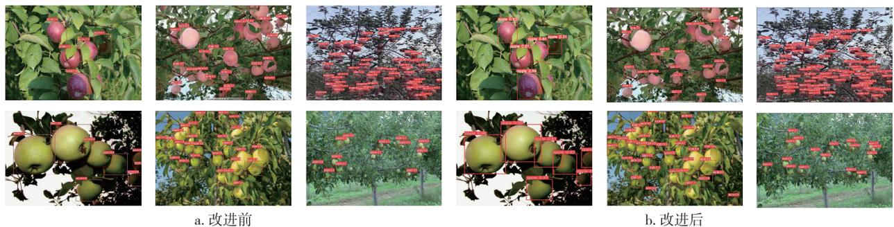
图 8 YOLOv8 改进前后对不同数量苹果的检测效果
