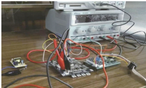
图 9 含 CPL 的升降压变换器实验平台 Fig. 9 Experimental platform for buck-boost converter with CPL
