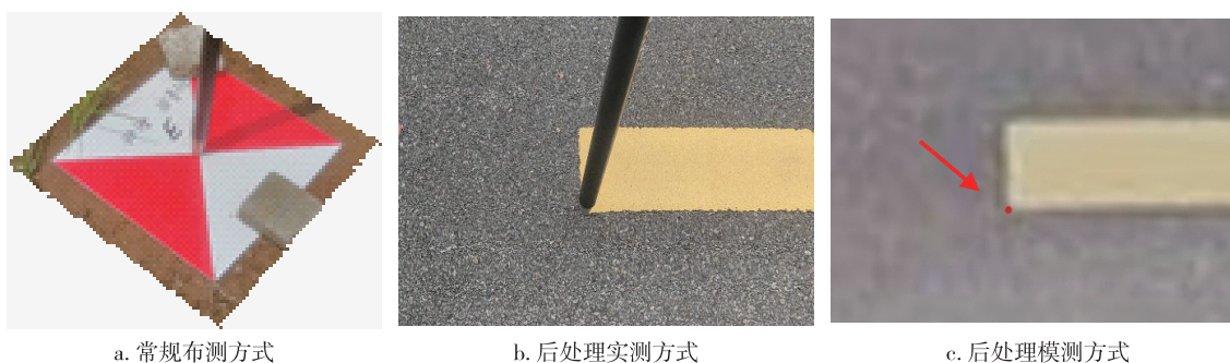
图3 像控点采集方式 Fig. 3 Collection of image control points
