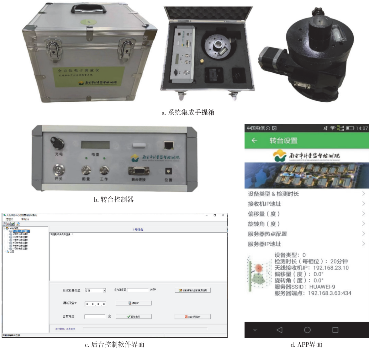
图7 天线相位中心偏差自动测量系统
