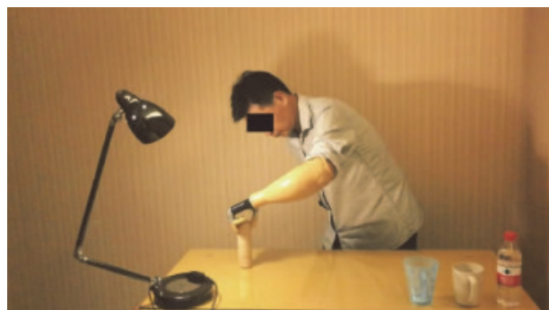
图3 东南大学与丹阳假肢厂联合研发的多指灵巧肌电假手 [8]
