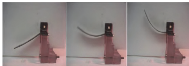
图8 离子型EAP变形 [19] Fig. 8 Ionic EAP deformation [19]
