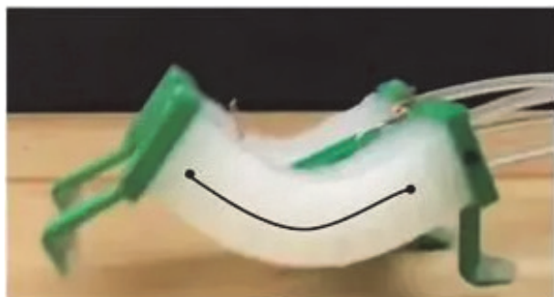
图6 仿猎豹柔性机器人 [11] Fig. 6 Flexible robot imitating cheetah [11]
