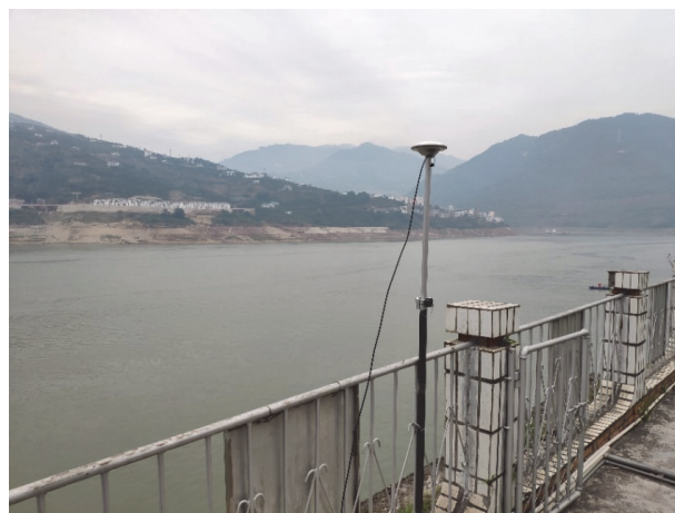
图 4 巴东站 GNSS-IR 测站 Fig. 4 Appearance of GNSS-IR station at Badong station
