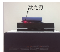
图 9 激光源标定坐标原点
