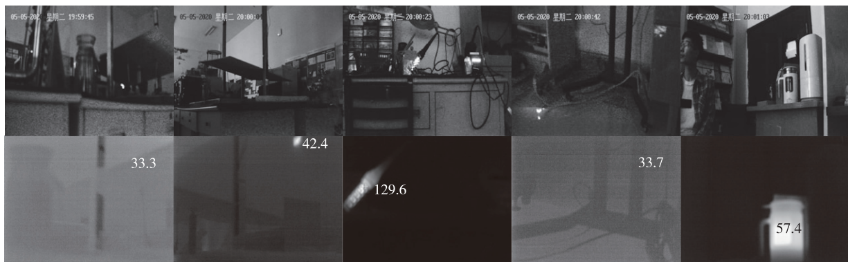
图9 巡检点处热成像物体测温结果
