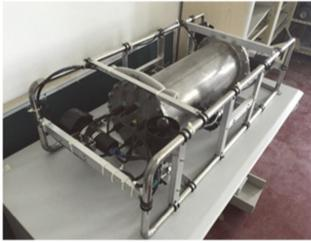
图6 遥控水下机器人实物
