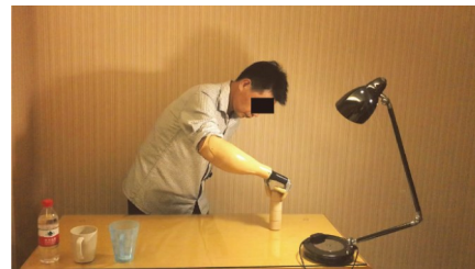
图9 东南大学与丹阳假肢厂联合研发的多指灵巧肌电假手 [27]
