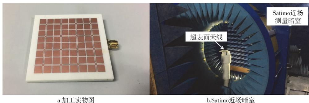
图 10 条带加载型小型化超表面天线的加工测试图
