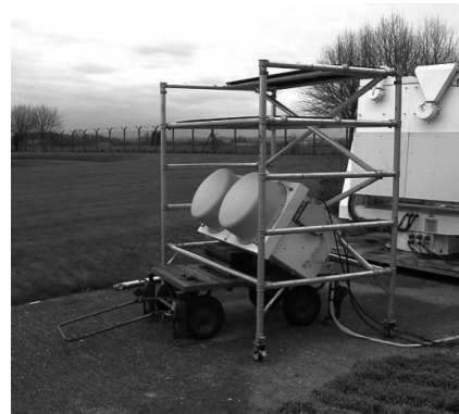
图 1 2002 年 3 月 14 号 Galileo 雷达的定标情况,其抬升角为 30^\circ ,脚手架避免雨水对毫米波雷达天线罩的影响
