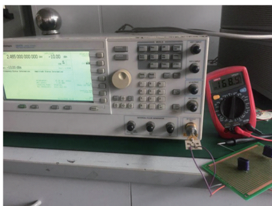
图7 使用矢量信号发生器测试
