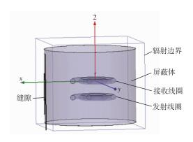
图 3 圆柱体屏蔽模型 Fig. 3 Cylinder shielding model
