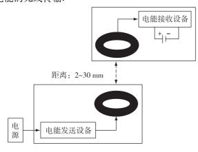
图 2 充电系统组成结构示意
