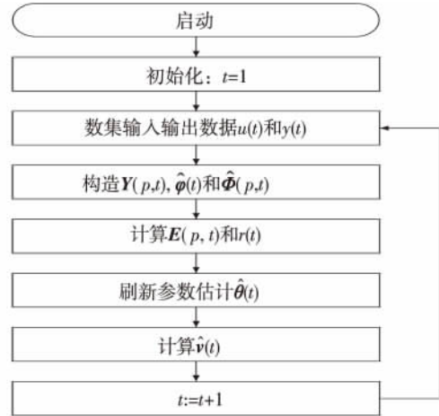
图 3 MI-ESG 算法计算参数估计 \hat{\theta}(t) 的流程
