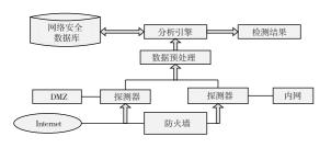
图 2 基于网络的入侵检测引擎结构
