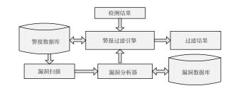
图 4 漏洞扫描引擎结构
