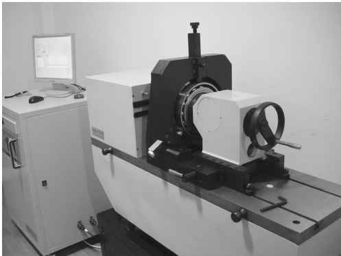
图3 轴承综合参数检查仪
