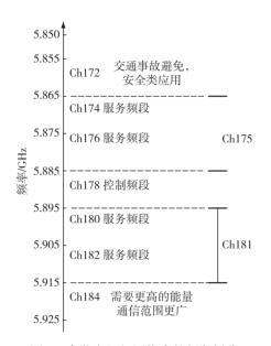
图 1 车载自组织网络中的频段划分 Fig. 1 Channel division of VANET
