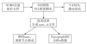
图 6 SUMO 和 NS2 的耦合过程 Fig. 6 Combination of SUMO and NS2
