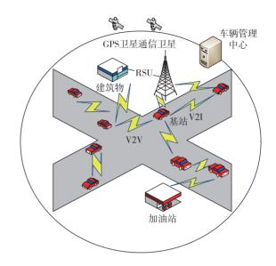
图 2 车载自组织网的系统模型
